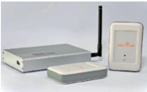
MONITORAGGIO. Sensori di temperatura e Data Storage Gateway utilizzati per il monitoraggio ambientale nel caso di studio esaminato (sistema Weolo).
